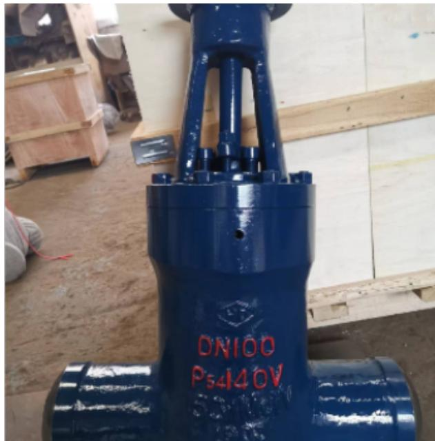
闸阀一般由阀杆、阀体、阀盖、闸板、驱动装置及其他零件（紧固件、阀杆螺母、密封填料）组成，下面逐一介绍其结构：阀杆闸阀阀杆按运动形式分为明杆（升降轴）和暗杆（旋转轴），闸阀因此而分为明杆闸阀和暗杆闸阀两种。1、明杆闸阀。手轮（或其他驱动装置）固定在阀杆螺母上，当手轮（或其他驱动装置）转动带动阀杆螺母旋转时，阀杆作上下移动，从而带动闸阀作升降运动而启闭管路。暗杆闸阀由于阀杆螺纹部分和阀杆螺母均在阀腔内部与介质接触，因而，易受介质腐蚀，阀杆螺纹等难于润滑。福建美标闸阀生产厂闸阀，就选上海精一电站阀门有限公司，让您满意，欢迎您的来电哦！
