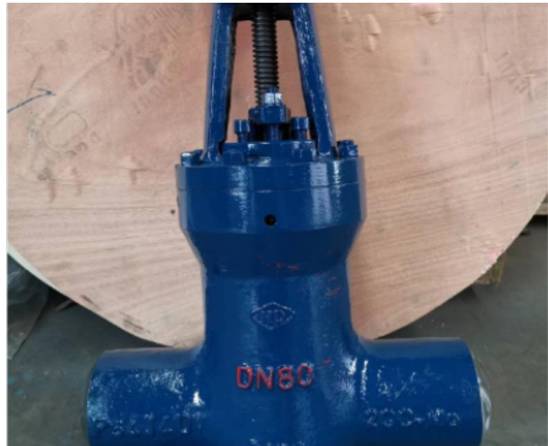
实际使用时，是以阀杆的顶点作为标志，即开不动的位置，作为它的全开位置。为考虑温度变化出现锁死现象，通常在开到顶点位置上，再倒回 $1/2$ — $1$ 圈，作为全开阀门的位置。因此，阀门的全开位置，按闸板的位置（即行程）来确定。有的闸阀阀杆螺母设在闸板上，手轮转动带动阀杆转动，而使闸板提升，这种阀门叫做旋转杆闸阀或叫暗杆闸阀。国内生产闸阀的厂家比较多，连接尺寸也大多不统一。主要分以下几个大类：1、按JB/T2203—1999《闸阀结构长度》生产的机械部标准阀门；2、按GB/T12221-2005《金属阀门结构长度》生产的国标阀门；3、按ASMEB16.10-2009《阀门的面对面及端对端尺寸》生产的美标阀门。
